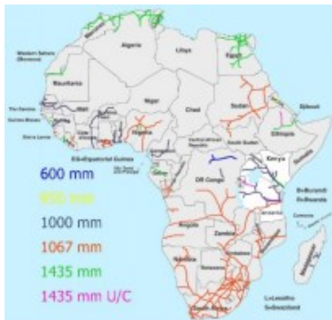
Figura 3 – Mappa delle ferrovie africane del 2017 nella quale sono evidenziati a colori i diversi scartamenti
